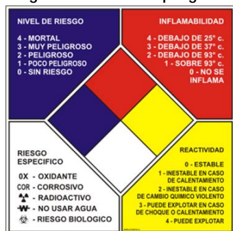
Imagen: Diamante del peligro del NFPA 704
